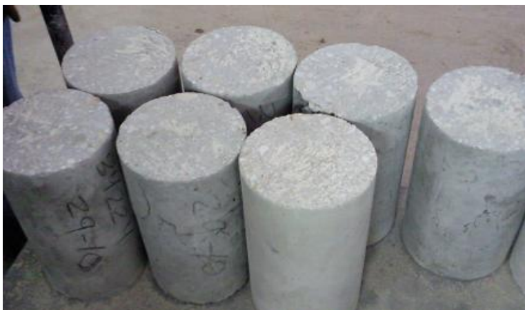
Figura 13.- Probetas pulidas preparadas para ensayar.
