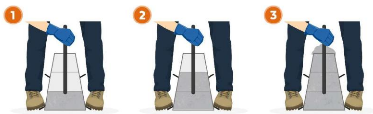
Figura 11.- Llenado de Cono de Abrams con hormigón fresco.
