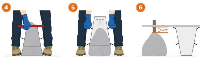
Figura 12.- Medida correcta de Cono de Abrams con hormigón fresco.
