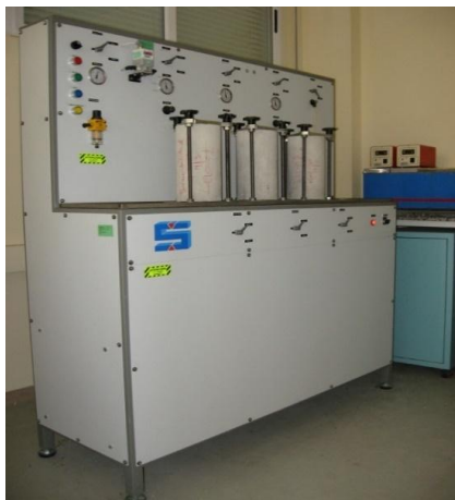
Figura 16.- Ejemplo de equipo de penetración de agua.
