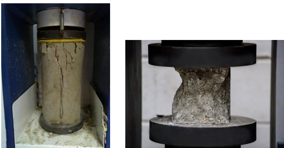
Figura 15.- Roturas a compresión de Probeta cilíndrica (izquierda) y Cúbica (derecha) en Prensa Hidráulica.
