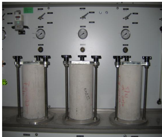
Figura 16.- Ejemplo de equipo de penetración de agua.
