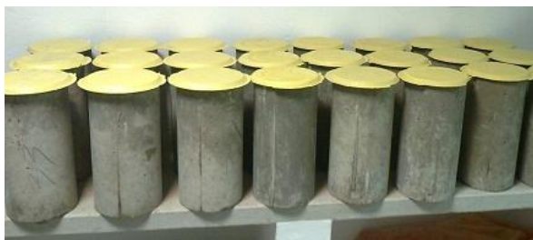
Figura 14.- Probetas refrentadas con mortero de azufre preparadas para ensayar.
