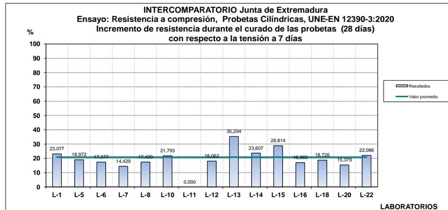
**GRUPO D: ENSAYOS DE HORMIGÓN ESTRUCTURAL**
